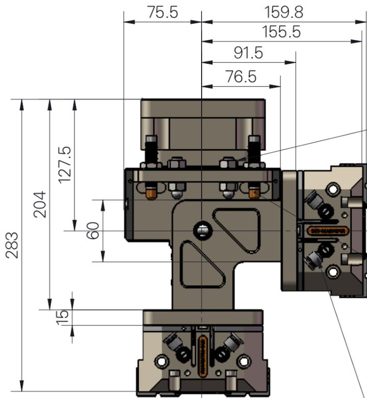
此为硬定位调节螺钉, 待缓冲缸调节到旋转准确位置后, 调节此两个螺钉, 使起始角度和终止角度在正确位置, 拧紧螺母固定, 确保重复精度在指定范围内。
